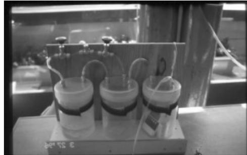
圖十、自製小型氮氣燻蒸庫
