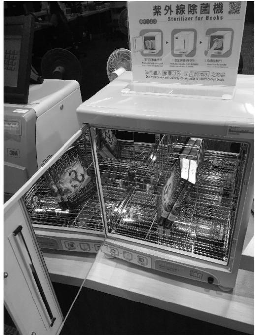
圖 6：設置紫外線除菌機，讀者借書後，可自助式操作進行圖書消毒
